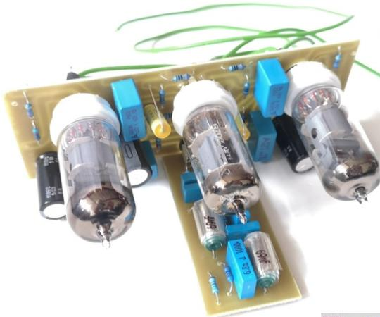
Für die Plattenspieler-Wiedergabe haben wir einen MM-Phono-Entzerrer auf Röhrenbasis entwickelt. Die Platinen sind komplett bestückt und getestet (min. 2h aktiver Betrieb). Drei Röhren sorgen für die Verstärkung des pegelschwachen Tonabnehmer-Signals. Die MC-Version (oder MM/MC) enthält noch eine weitere Platine eingepackt in einem HF-Gehäuse.
